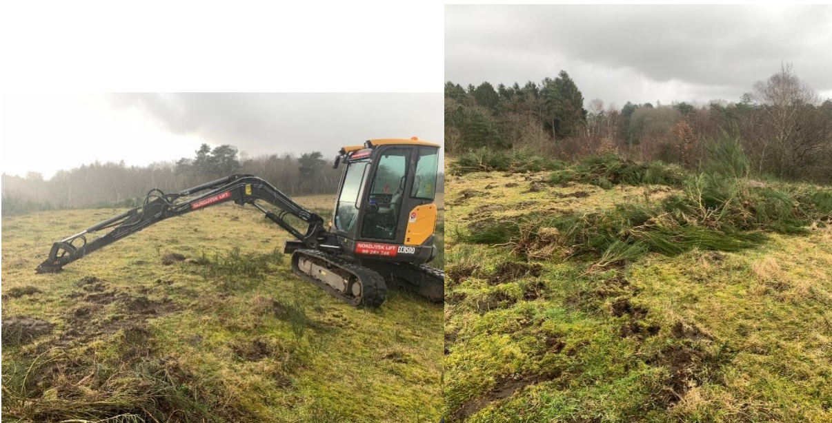
Figur 2: Gyvel og birk trækkes op med en særlig klo/tang, der klemmer om stammen, hvorved planten med rod kan trækkes op.
