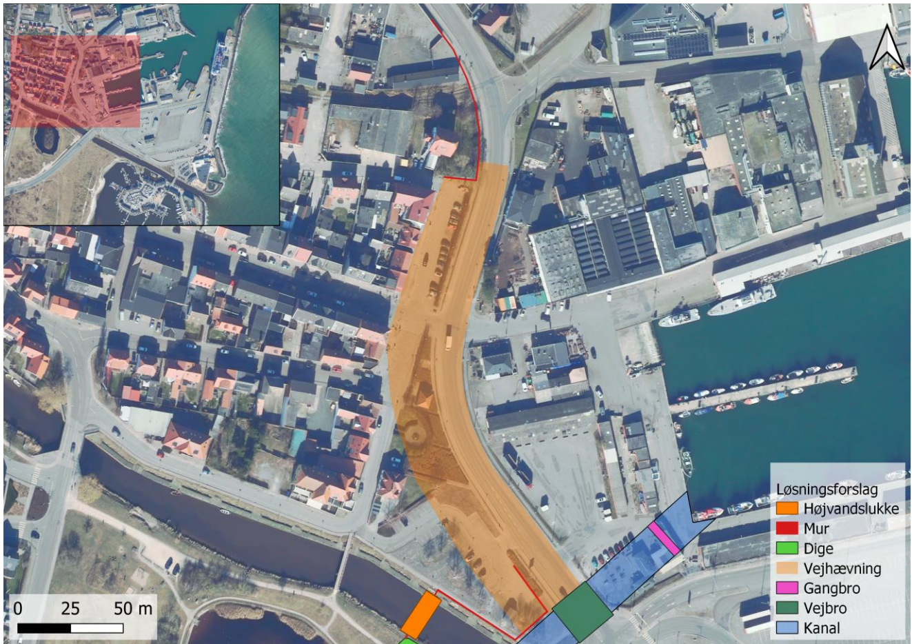
Figur 4.8: Mur og vejhævning ved Kattegatvej.
